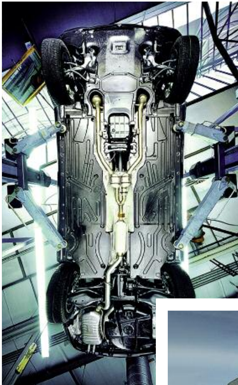
Rysunek 20: Samochodowe układy wydechowe są zwykle wytwarzane ze stali nierdzewnej. Gumowe elementy połączeń przeciwdziałają korozji galwanicznej.
